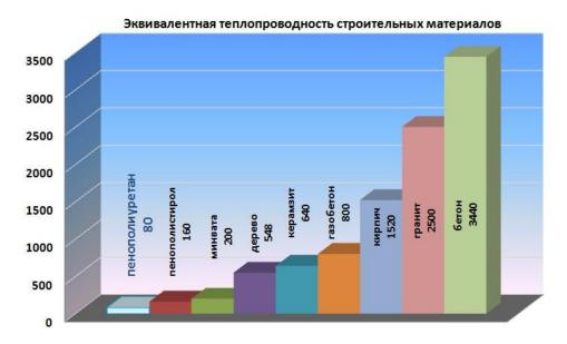
При строительстве из контейнеров, для погодных условий Москвы достаточно 10 см пенополистирольной плиты в наружном утеплении строительной конструкции, независимо от материалов самой конструкции.
